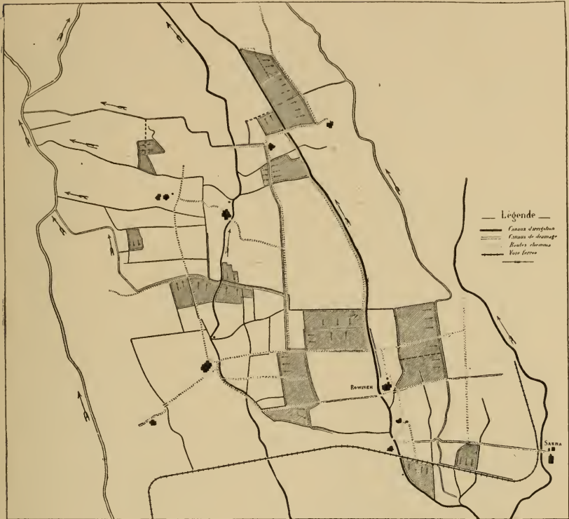
FIG. 46. — Sakha. Administration des domaines, Testiche de Rowineh : Disposition et enchevêtrement des canaux d'irrigation et des canaux de drainage (masrâfs) dans les parties septentrionales du Delta. 1 : 150 000.
